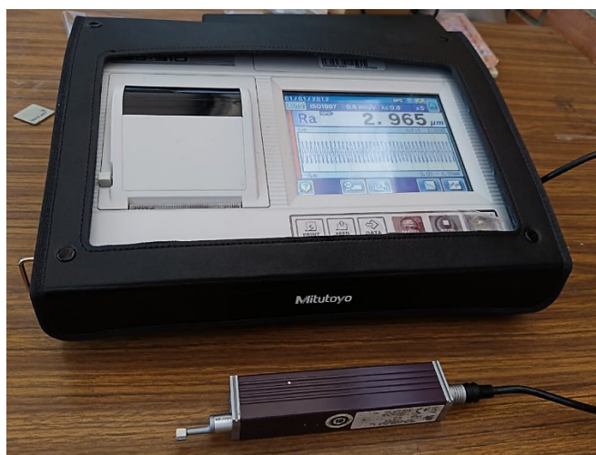
Figura 6. Rugosímetro Mitutoyo Surf test SJ-310.
