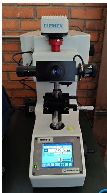
Figura 4. Microdurómetro MATSUZAWA MMT-X.
