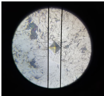
Figura 5. Marca de indentación del microdurómetro.
