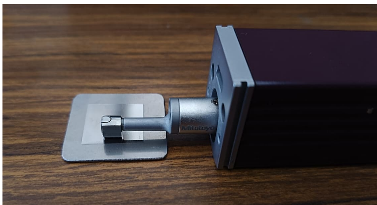
Figura 7. Palpador y medida de rugosidad de las muestras.
