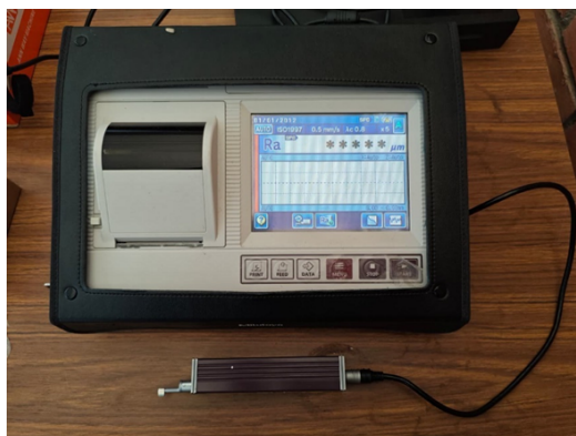
Figura 3. Rugosímetro Mitutoyo Surftest SJ-310.
