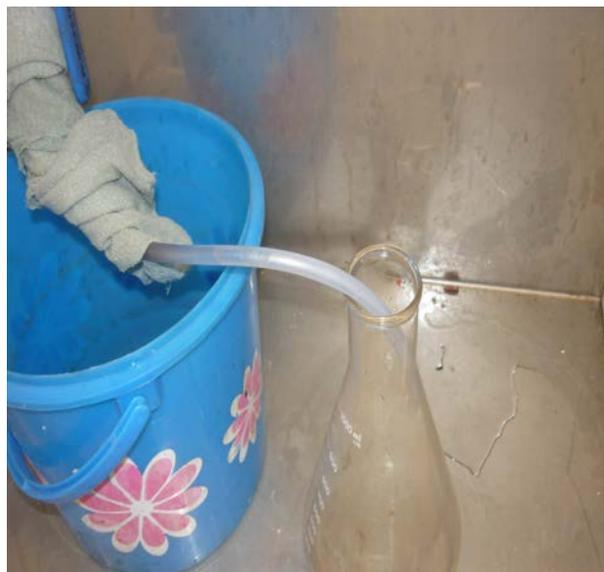
Figura 4 Recolección de mezcla Etanol-Agua en matraz de Erlenmeyer.
