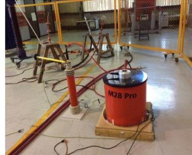
**IMAGEN 2. Fuente de generación de descargas parciales oscilante.**
