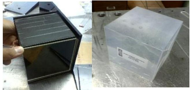
**Fig.3: Plástico centellador y módulo de plástico centellador.**
