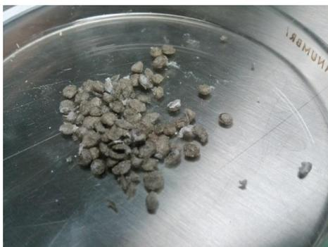
**IMAGEN 4: Esferas liofilizadas de QT/PVA/MMT entrecruzadas con genipina y por criogelación, previo a ser molidas para la obtención de su espectro FT-IR.**
