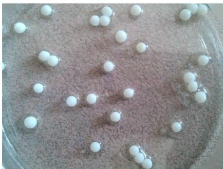
**IMAGEN 3: Esferas de QT/PVA/MMT entrecruzadas con éster de ácido cítrico y por criogelación durante la realización de las pruebas de hinchamiento.**
