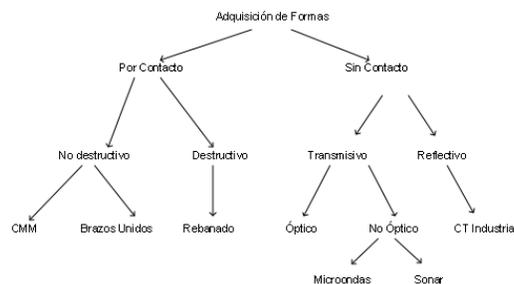
Figura 1. Tipos de Adquisición 3-D de Objetos (Rocchini, 2001)
