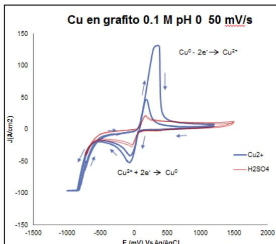
**Diagrama 5.** Voltametría cíclica para  $\text{Cu}^{2+}$  en grafito a 0.1M-y pH = 0 (Creación propia)
