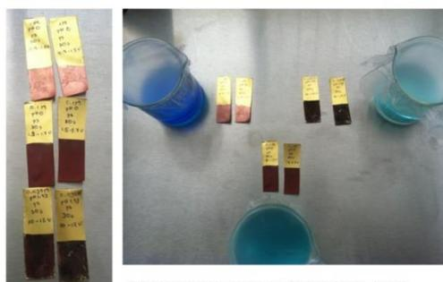
Fig. 14. Resultado obtenido de cobrizado con panel FV a diferentes concentraciones y pH.
