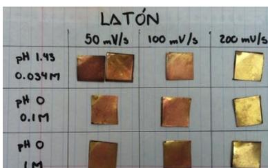
Fig. 1. Resultados de la caracterización electroquímica con láminas de latón a diferentes velocidades y pH. (Creación propia)
