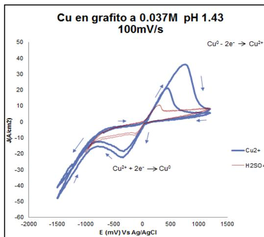
**Diagrama 6.** Voltametría cíclica para  $\text{Cu}^{2+}$  en grafito a 0.037M y pH = 1.43 (Creación propia)
