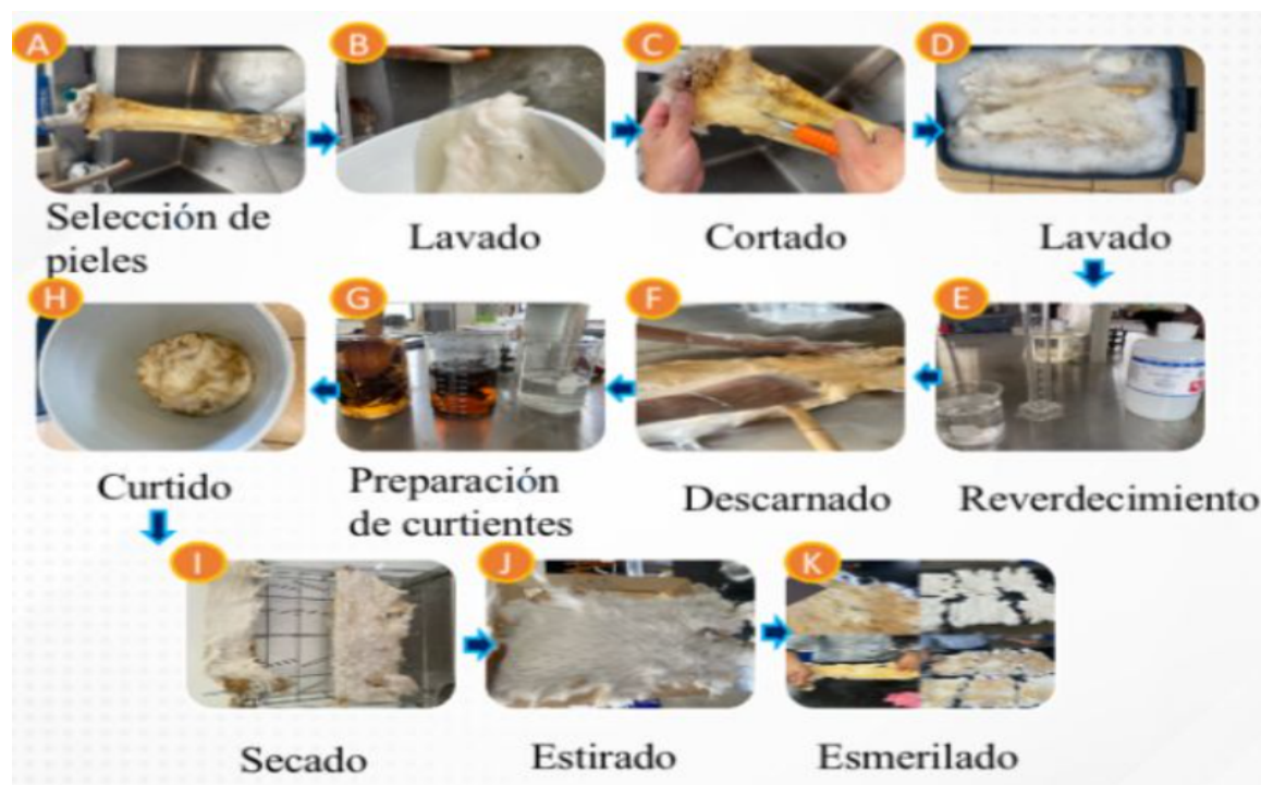
Figura 1. Diagrama de flujo que muestra las diferentes etapas del proceso de curtido de la piel de conejo. Fuente: Autoría propia.
