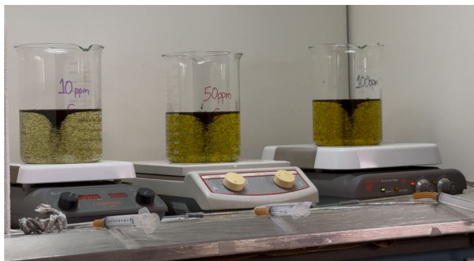
Figura 1. Cinética de adsorción de Cr(VI) sobre residuo de café para concentraciones iniciales del ion metálico: 10, 50 y 100 mg/L.
