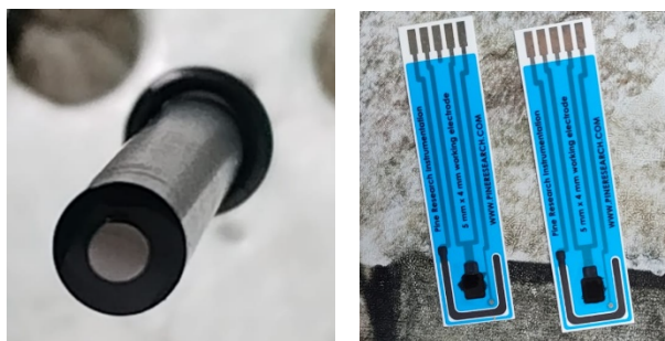
Figura 1. a) Electrodo de carbón vítreo. b) Electrodo serigrafiado.
