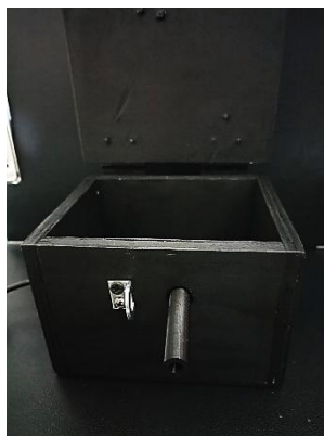
Figura 6. Estructura física con aislamiento óptico.
