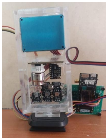
Figura 4. Conjunto de sensores conectados a la placa LILYGO
