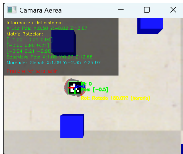
Figura 4. Vista desde la cámara aérea hacia el robot terrestre, detectando el marcador visual.
