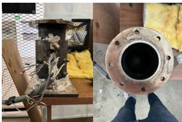
Figura 6. Reactor pirolizador experimental del laboratorio de termofluidos (prototipo de banco de 2 litros de volumen) en la Universidad de Guanajuato Campus Irapuato-Salamanca.
