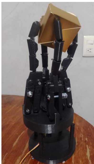
Figura 10. Gripper sosteniendo una caja pequeña.
