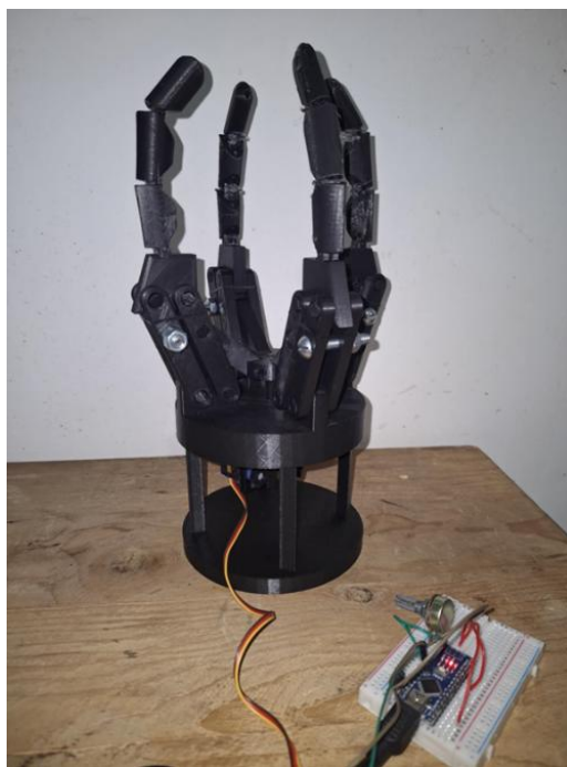
Figura 9. Gripper implementado con Arduino Nano y servo SG90.
