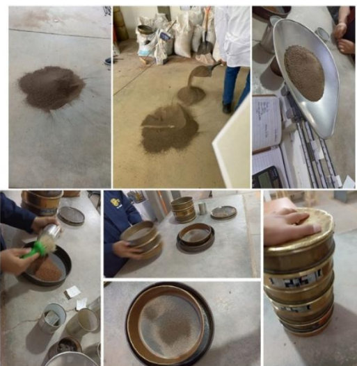
Figura 5. Representación del proceso de granulometría hecho en el laboratorio la Perlita. Fuente: Elaboración propia.
