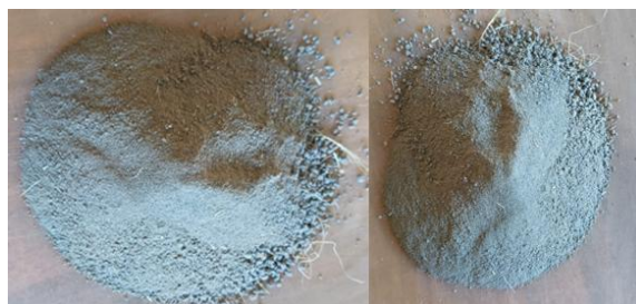
Figura 1. Muestras de suelo utilizadas para la elaboración de adobes. Fuente: Elaboración propia.
