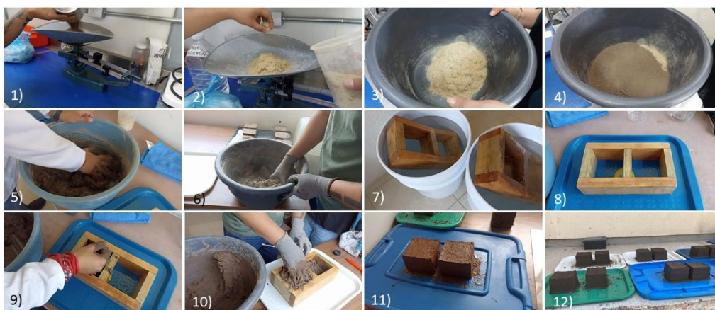
Figura 6. Proceso de elaboración de los especímenes de adobe propuestos. Fuente: Elaboración propia.
