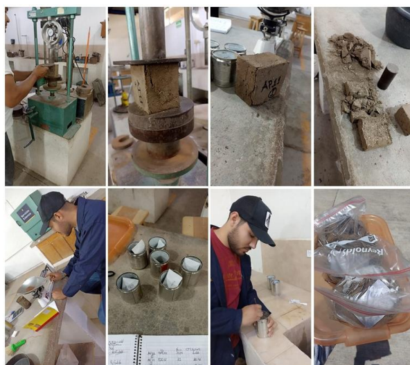
Figura 8. Imagen de la realización de la prueba de compresión en el laboratorio de suelos. Fuente: Elaboración propia.
