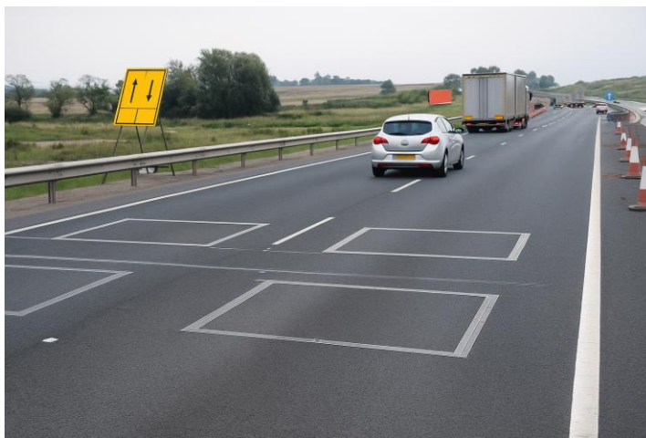
Figura 1. Ejemplo de un sistema WIM que emplea sensores piezoeléctricos y lazos electromagnéticos instalados en cada carril para registrar en tiempo real las características estructurales y dinámicas de los vehículos conforme atraviesan la zona de medición.
