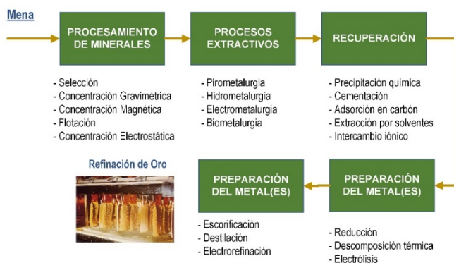
Figura 1. Etapas metalúrgicas para llevar las menas minerales a metales [1].
