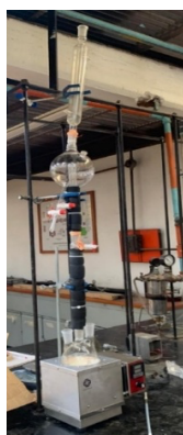
Figura 2. Columna de destilación reactiva para la reacción de transesterificación en el laboratorio. Fuente: Autoría propia.
