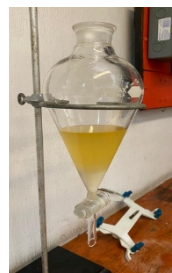
Figura 20. Separación de fases del producto en P2. Fuente: Autoría propia.
