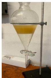
Figura 19. Separación de fases del producto P1. Fuente: Autoría propia.
