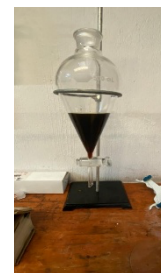
Figura 20. Separación de fases del producto P3. Fuente: Autoría propia.
