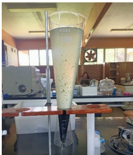
Figura 3. Sólidos sedimentables en cono Imhoff.
