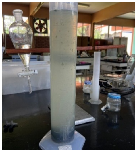
Figura 4. Sólidos sedimentables en probeta.
