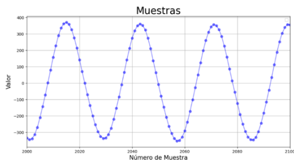
Figura 2. Señal registrada de la señal emitida a 98 Hz.
