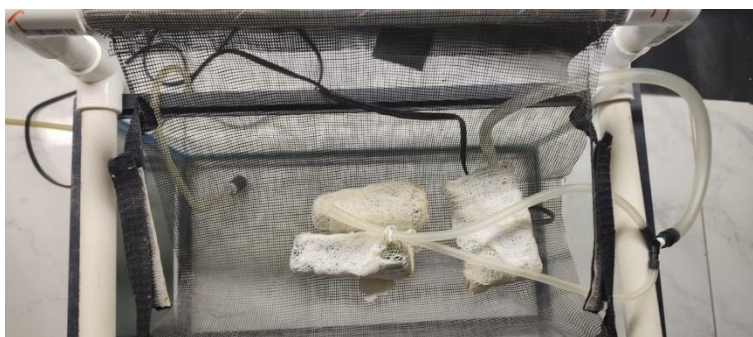
Figura 3. Conducto de flujo de agua. Se observa una vista superior a la camilla, y las mangueras que forman la línea de conducción de agua, de la bomba sumergible a la boca del pez.
