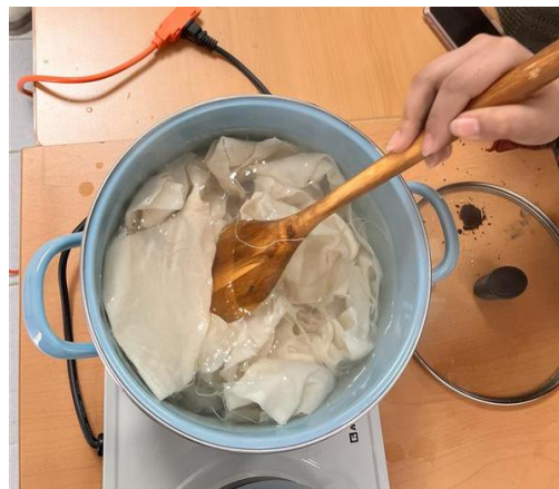
Figura 2. El premordentado: proceso en el que la tela se cocina en agua con alumbre. Nota: Fotografía cortesía del archivo del grupo de investigación.
