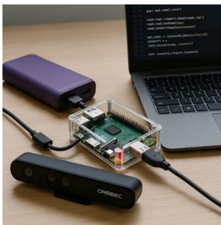
Figura 4. Arquitectura hardware del sistema portátil para detección de objetos.
