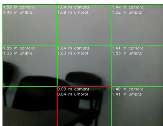
Figura 3. Medición de proximidad en tiempo real y ubicación relativa de objetos en un salón de clases de DICI.
