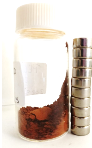
Figura 6. Respuesta magnética de las partículas de magnetita ( \text{Fe}_3\text{O}_4 ) ante la proximidad de un imán de neodimio.
