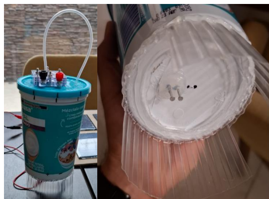
Figura 1. Electrolizador casero elaborado con materiales reciclados.
