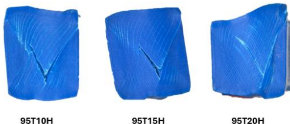
Figura 6. Fisura presentada en la cara xy superior de las probetas ensayadas a compresión después del tratamiento térmico a 95 °C a diferentes tiempos de exposición.
