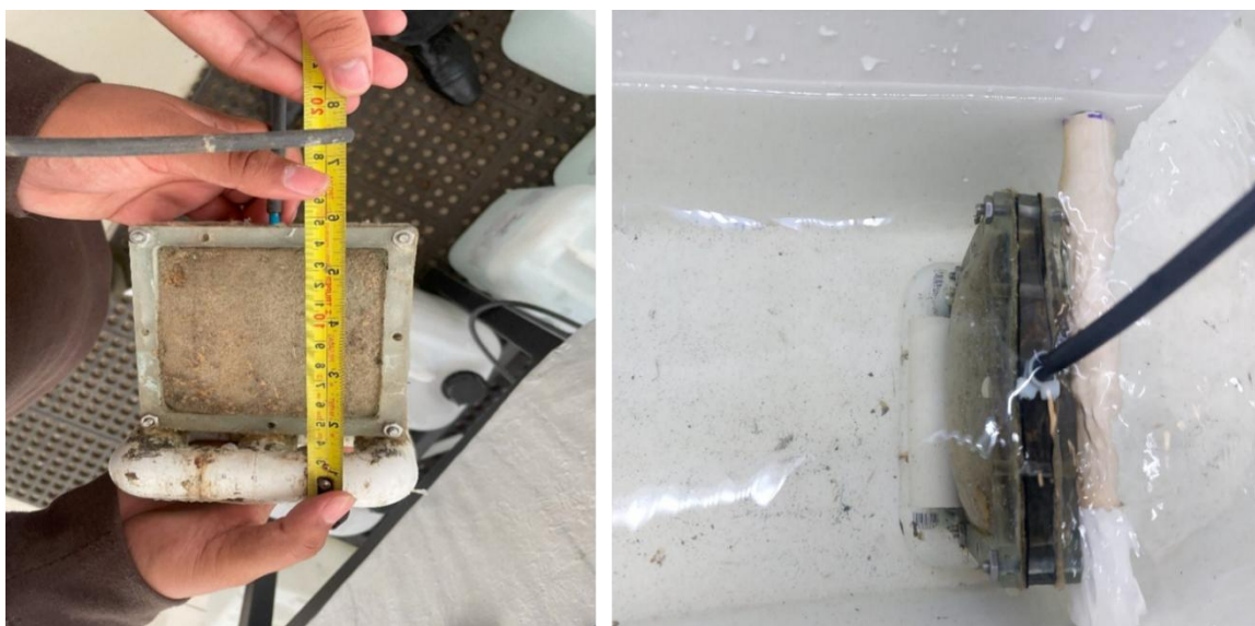
Figura 2. Módulo de filtración con membranas dinámicas.
