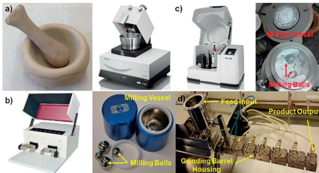
Figura 1. a) Mortero y pistilo manuales (izq.) y un mortero mecanizado (der.), b) Molino agitador (izq.) con ejemplos de las bolas de molienda y sus reactores (der.), c) Molino planetario (izq.) con ejemplo de su reactores (der.), d) Extrusor continuo. Tomado de Frišić y Tan. 14
