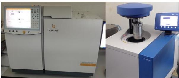
Figura 7. Cromatógrafo de gases y bomba calorimétrica.
