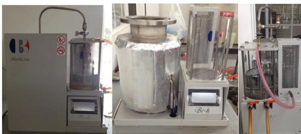
Figura 4. Prototipo para la pirólisis del plástico.
