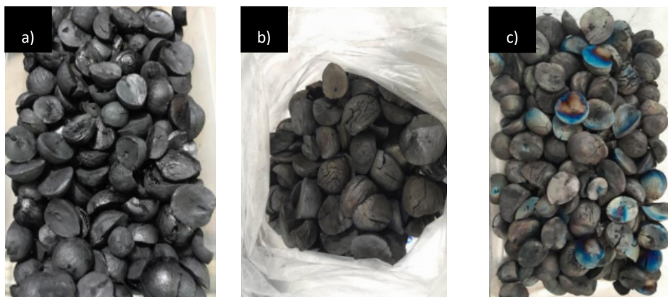
Figura 5. Muestras de biocarbón almacenadas y seleccionadas: a) biocarbón a 300 °C; b) biocarbón a 400 °C; c) biocarbón a 600 °C.
