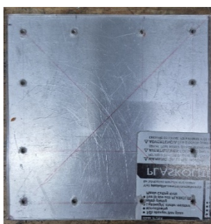
Figura 6. Fotografía de las láminas de Aluminio para la parte superior y la parte inferior de los planos de detección a base de tubos Geiger-Müller. Foto propia.
