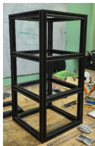
Figura 5. Fotografía del soporte construido a partir de extrusiones de Aluminio. Foto propia.
