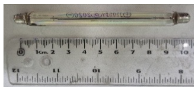
Figura 7. Fotografía de un tubo Geiger-Müller. Foto propia.
