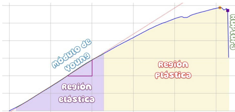
Figura 1. Curva esfuerzo-deformación de una muestra de acero galvanizado. Se observa la región elástica (en morado), la estimación del módulo de Young (pendiente roja) y la región plástica (en amarillo) hasta el punto de ruptura.
