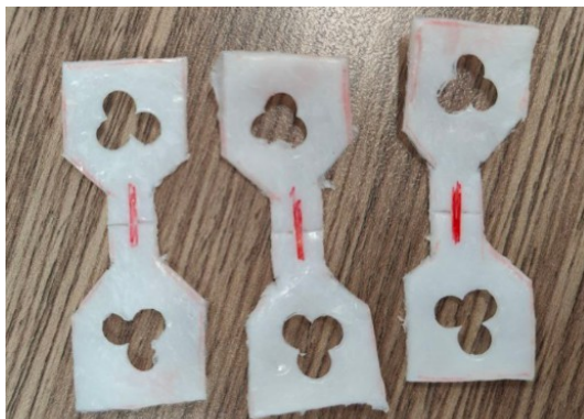
Figura 6. Probetas de policaprolactona en forma de "Hueso de perro". Las probetas se diseñaron según la norma ASTM D638, adaptadas a las dimensiones operativas de la máquina. Su geometría permite una mejor alineación axial y reduce concentraciones de esfuerzo en la zona de sujeción.
