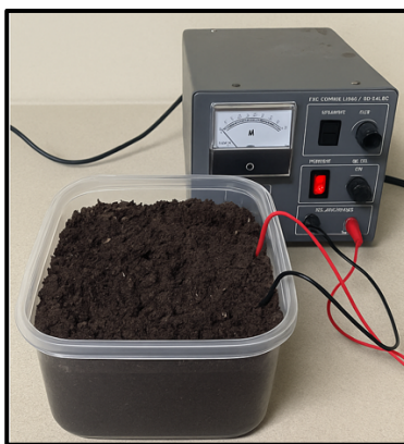
Figura 1. Sistema de electrocultivo empleado en el estudio. Fotografía del sistema experimental real, mostrando la fuente de poder conectada a la bandeja plástica utilizada como cámara de germinación (Elaboración propia).
