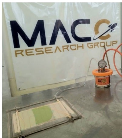
Figura 2. Configuración del sistema de vacío. Fuente: Fotografía de elaboración propia.
