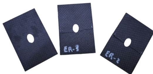
Figura 7. Especímenes con concentradores de esfuerzo ovalados con velos fracturados. Fuente: Fotografía tomada por los autores.
