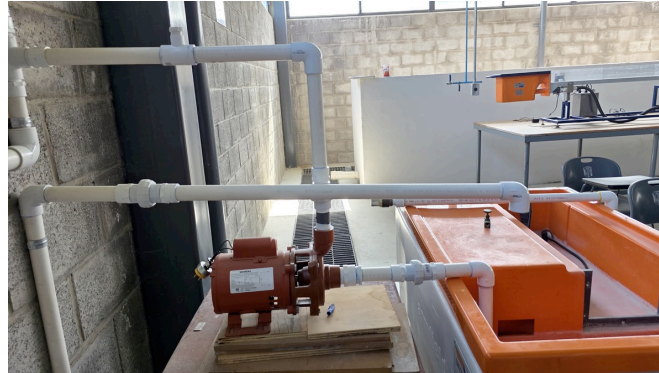
Figura 5. Descarga del T.E. al BM y conexión de la bomba de 1/2 hp al BM (Fuente: elaboración propia).
