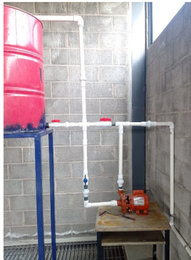
Figura 4. Conexión de la bomba de ¼ hp al T.E. (Fuente: elaboración propia).
