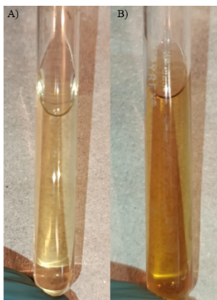
Figura 3. A) Reacción del blanco con acetona 20% y \text{H}_2\text{SO}_4 . B) Reacción de los cristales obtenidos de la muestra 5:1 con acetona 20% y \text{H}_2\text{SO}_4 .
