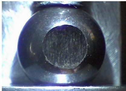
Figura 1.2. Huella de desgaste resultante de la prueba Timken.
