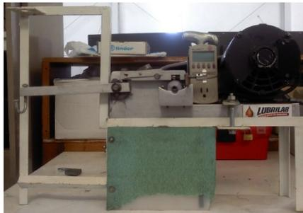
Figura 1.1. Tribómetro de laboratorio.
