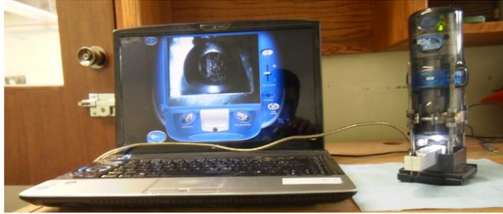
Figura 3.1. Captura de la imagen de la huella de desgaste en el balín.
