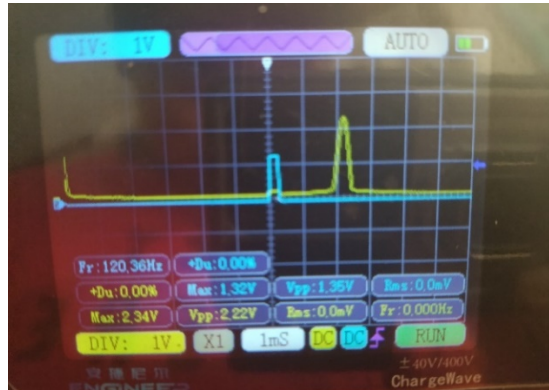
Ilustración 8 RETARDO DE 6000 US MOSTRADO EN EL OSCILOSCOPIO EN COMPARATIVA CON LA DETECCIN DE CRUCE POR CERO. Fuente: Elaboración propia.
