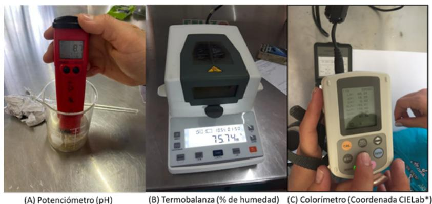
Figura 4. Fotografía de las pruebas realizadas: (A) análisis de pH, (B) Determinación del % de humedad, (C) Evaluación del color (fotografía autoría propia).
