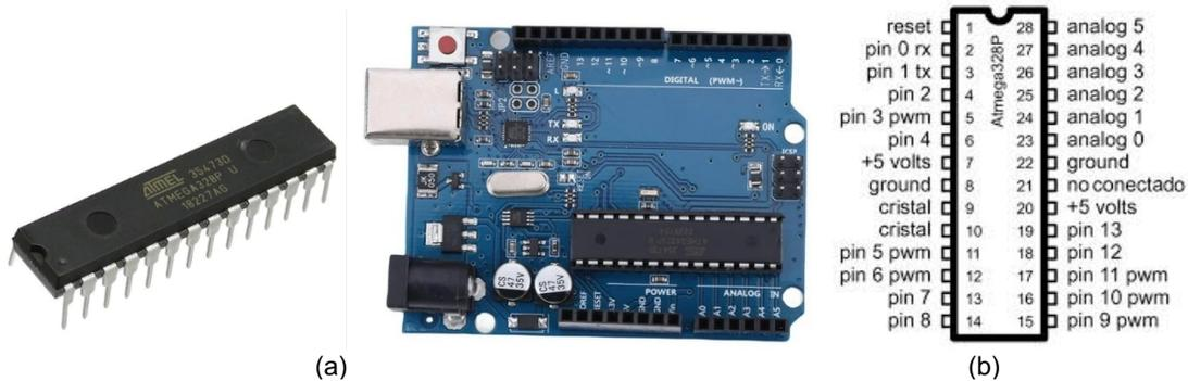
Figura 4. a) Sistema con microcontrolador ATmega328p y b) designación de terminales.
