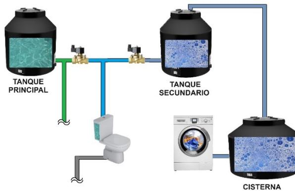
Figura 8 Esquema general de interconexión de tuberías al inodoro.
