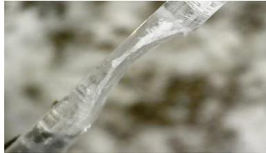
Figura 4 Muesca en D en una fibra óptica plástica.
