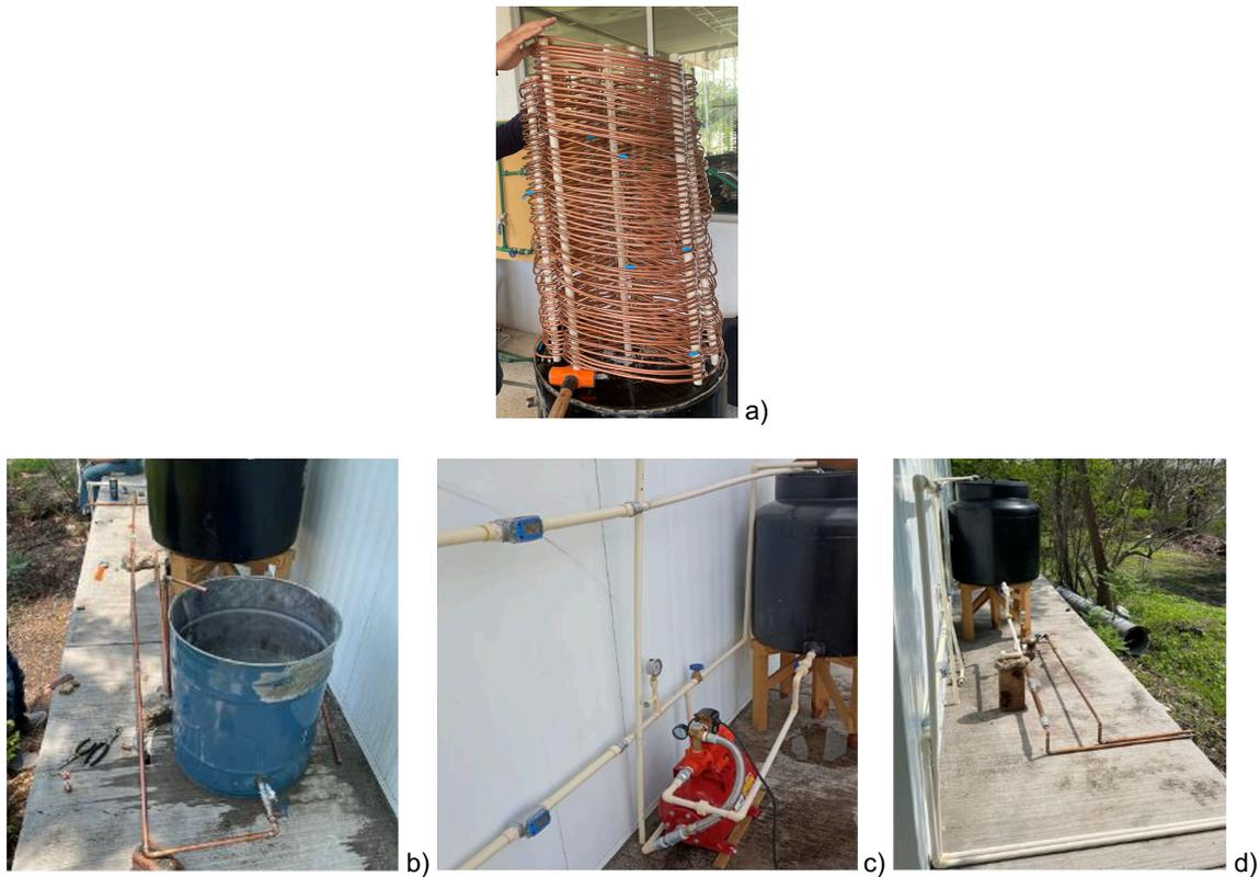
Figura 8. Serpentin del depósito de almacenamiento y componentes del set experimental.
