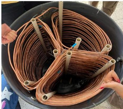
Figura 5. Arreglo del espiral para movimiento del aceite térmico a lo largo del depósito auxiliar.
