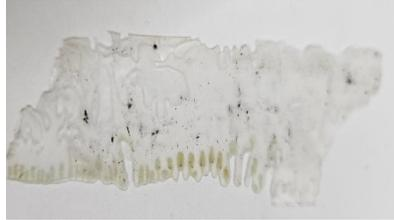
Figura 9. Arreglo de polietileno con nanoestructuras de alambre de NiCu SMA sometida a carga aplicada a 250°C.
