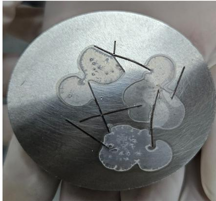
Figura 6. Arreglo de polietileno-NiCu sometida a carga aplicada a 250°C
