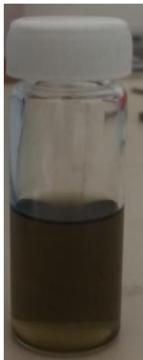
Figura 4. Líquido sobrenadante resultante de la síntesis por combustión (Abajo-Arriba), la cual se oxidó por 18hrs.
