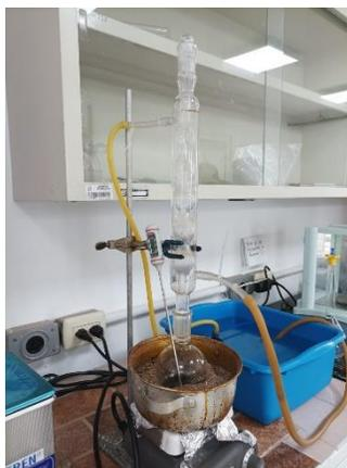
*Figura 3. Síntesis de PCC por método de combustión*
