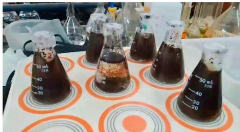
Figura 1. Sistema de agitación para la determinación del PCC.
