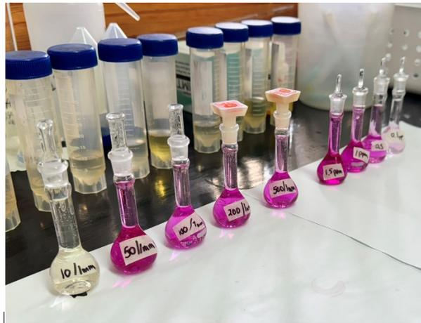
Figura 3. Análisis de Cromo VI por Espectrofotometría de UV-Visible.
