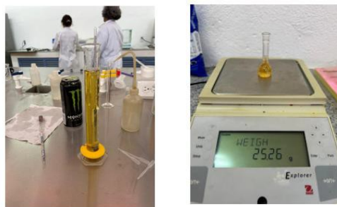
Figura 24. Determinación de la densidad de bebidas energizantes utilizando el densímetro y método indirecto
