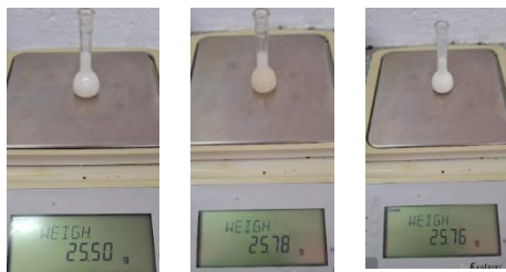
Figura 13. Determinación de la densidad relativa de muestras de fórmulas lácteas
