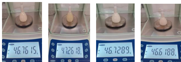
Figura 11. Determinación de la densidad del agua y muestras de fórmulas lácteas utilizando el picnómetro
