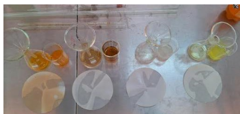
Figura 19. Determinación de presencia de residuos sólidos en las muestras de refresco.
