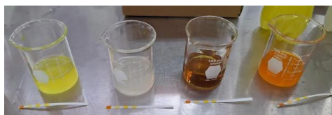
Figura 20. Determinación de pH en las muestras de refresco con el uso de tiras reactivas
