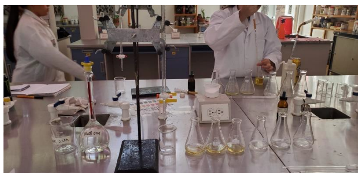
Figura 7. Titulación para la determinación de ácido cítrico utilizando NaOH 0.5 M como solución estándar
