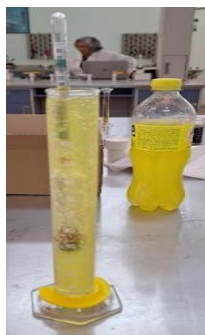
Figura 18. Determinación de la densidad de muestras de refresco
