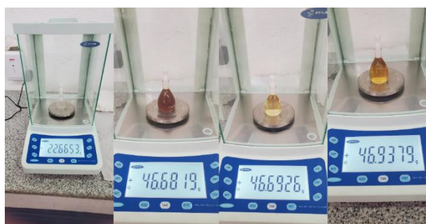
Figura 2. Determinación de la densidad del agua y muestras de diferentes jugos utilizando picnómetros
