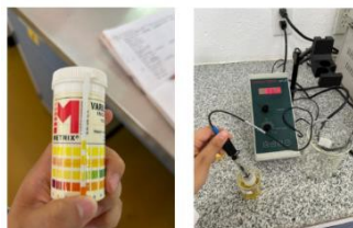
Figura 25. Determinación del pH de bebidas energizantes utilizando tiras reactivas y el potenciómetro
