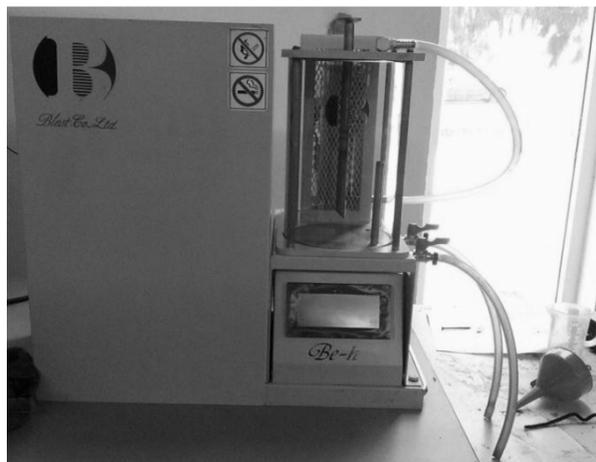
Figura 1.- Equipo experimental para la obtención de combustible mediante la pirólisis de desechos plásticos.
